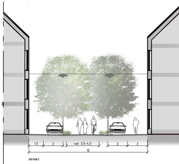
Figur 16: Gatusektion 3, gata mellan kvarteren i kvarteret Ekan.
