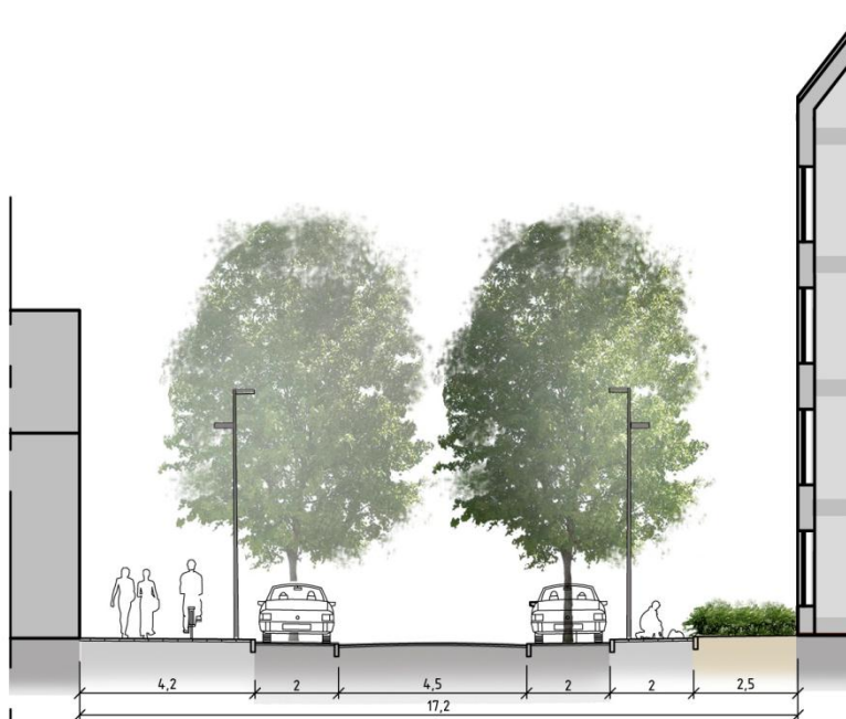
Figur 14: Gatusektion 1, infartsgatans entré mot Söraskolan.
